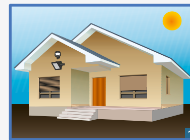
Mientras hay suficiente luz ambiental, el sensor mantiene apagada la carga. While there is enough ambient light sensor remains off the load.
